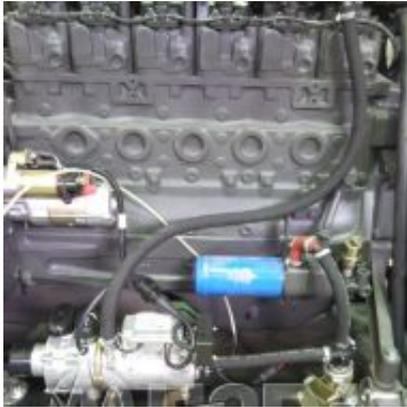
модель: **Предпусковой подогреватель дизельный Бинар 15 кВт**
